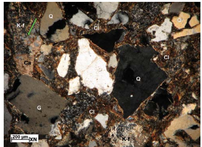
Hình 20. Ảnh thạch học độ sâu 4.030m giếng khoan 09-2/09-KNT-2X: Cát kết feldspathic greywacke hạt trung bình, chọn lọc kém. Độ rỗng nguyên sinh giữa các hạt bị mất hoàn toàn do vật chất đồng trầm tích
